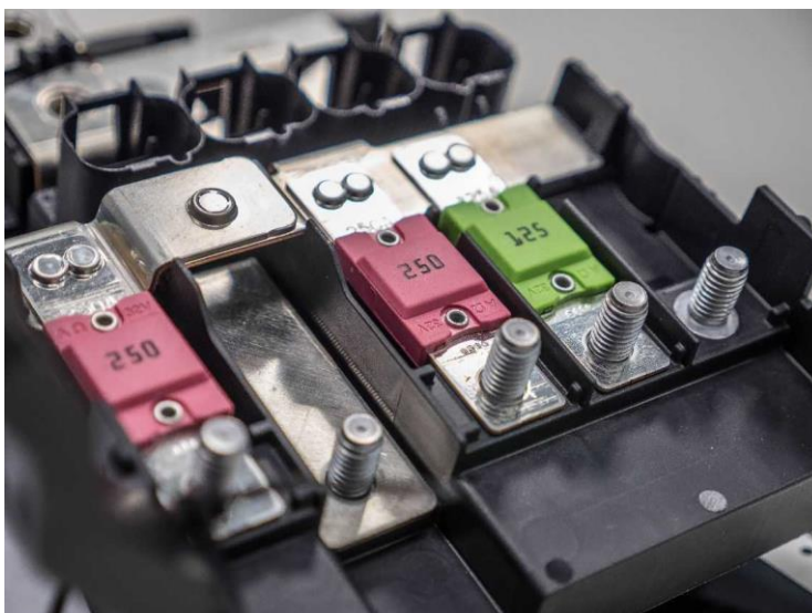
Bild 4: Mehrere eTWINpoints sowie ein eRund-Punkt innerhalb einer Pkw-Vorsicherungsdose
